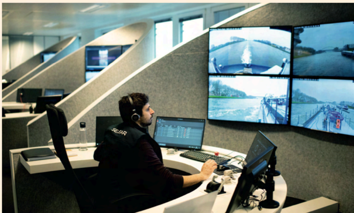
Pour piloter à distance ses péniches, Seafar y installe une série de capteurs, caméras, radars et lidars. © KATHIJN VAN GELSCHEPEN
